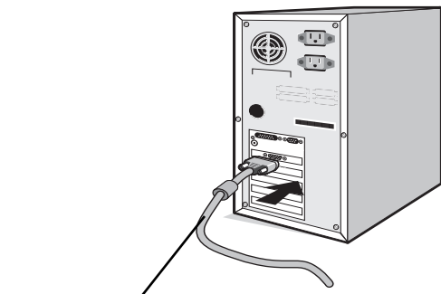
15-poliges Signalkabel Mini-D-SUB auf DVI-A* 1 (nicht mitgeliefert)
